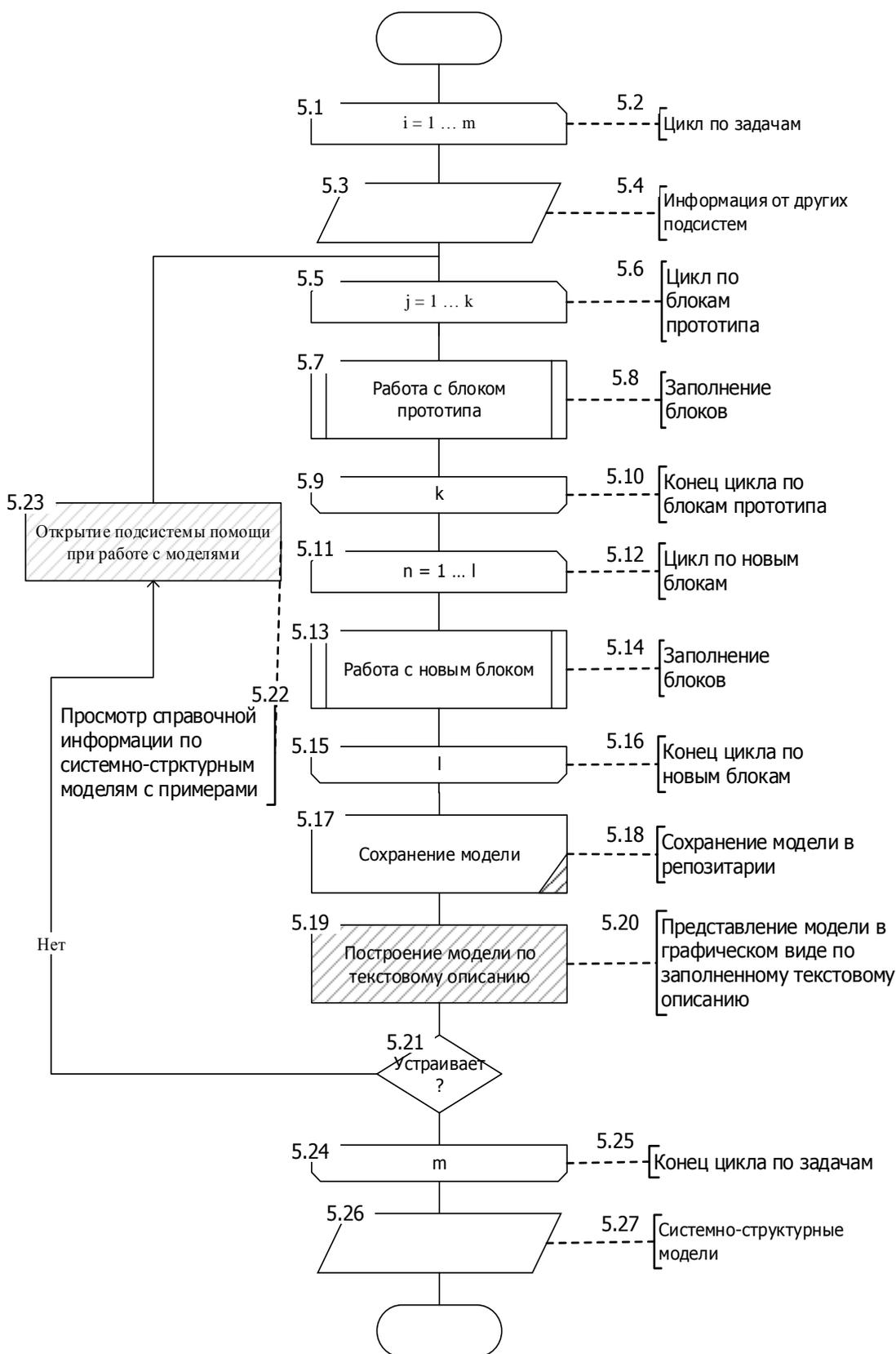
Рис. 8 – Алгоритм работы подсистемы работы с системно-структурными моделями по прототипу [6] и предлагаемому решению (выделено штриховкой)
