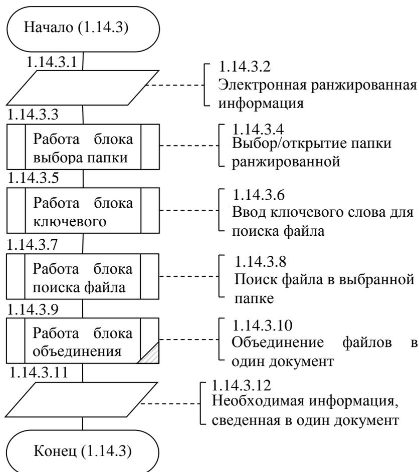
Рис. 9 Алгоритмическая модель модуля выбора файла (1.14.3)
