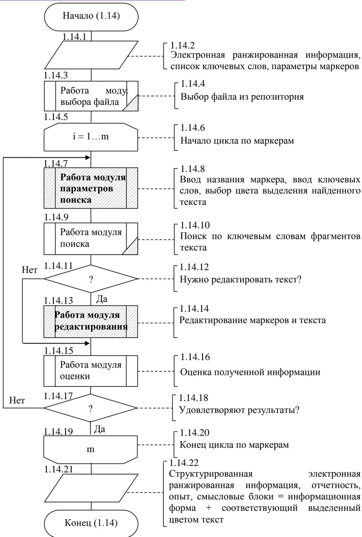
Рис. 8 Алгоритмическая модель подсистемы структуризации (1.14) по прототипу и предлагаемому решению (выделено штриховкой)
