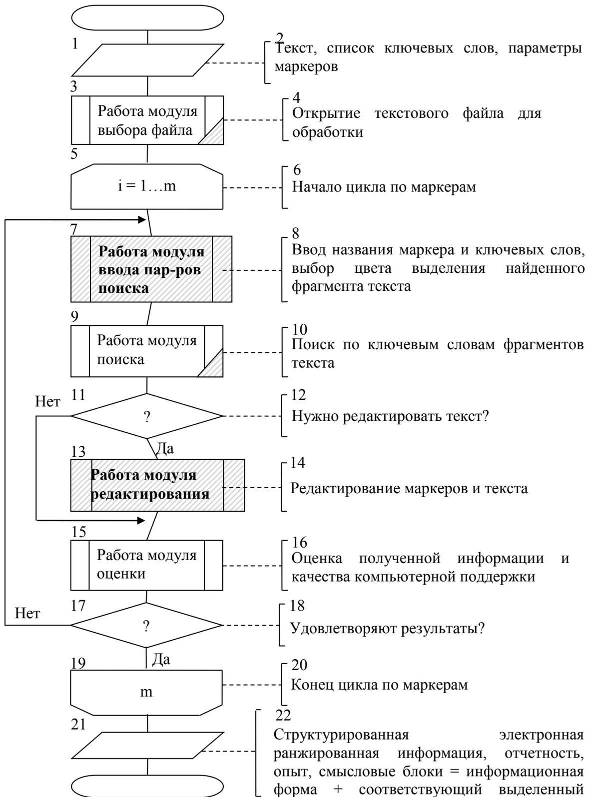
Рис. 4 – Алгоритмическая модель прототипа и предлагаемого решения (штриховка)
