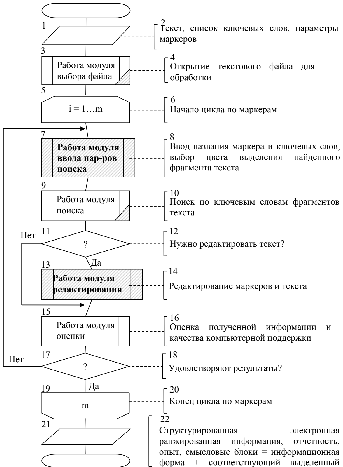
Рис. 4 – Алгоритмическая модель прототипа и предлагаемого решения (штриховка)
