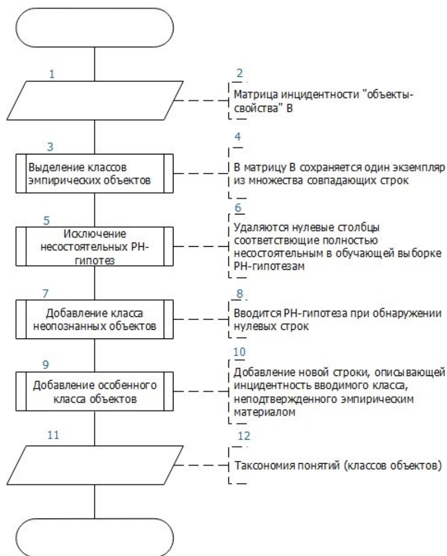
Рис. 4. Блок-схема метода построения онтологий предметных областей со структурными отношениями на основе анализа формальных понятий [13]
