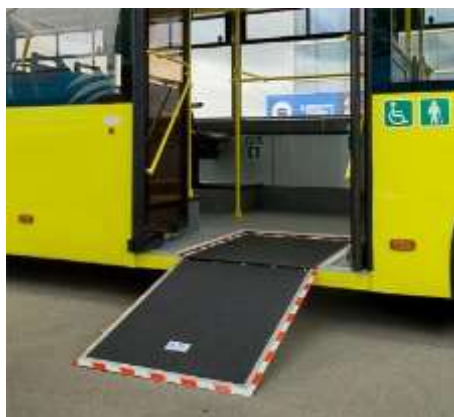
Рис. 16. Низкопольные автобусы, поднимающие свой передний конец на уровень земли и/или оснащенные пандусами, а не бортовыми лифтами
